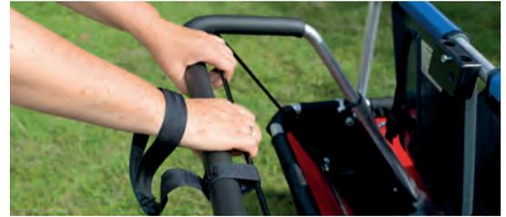
▲ Sicherheit und mehr Komfort bietet die Schlaufe, die den Bremsbügel fest am Handgriff hält. Wird der Handgriff losgelassen, löst sich die Schlaufe
